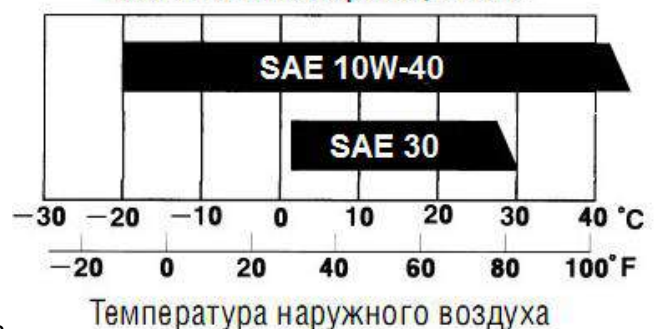
Классы вязкости моторного масла по классификации SAE
